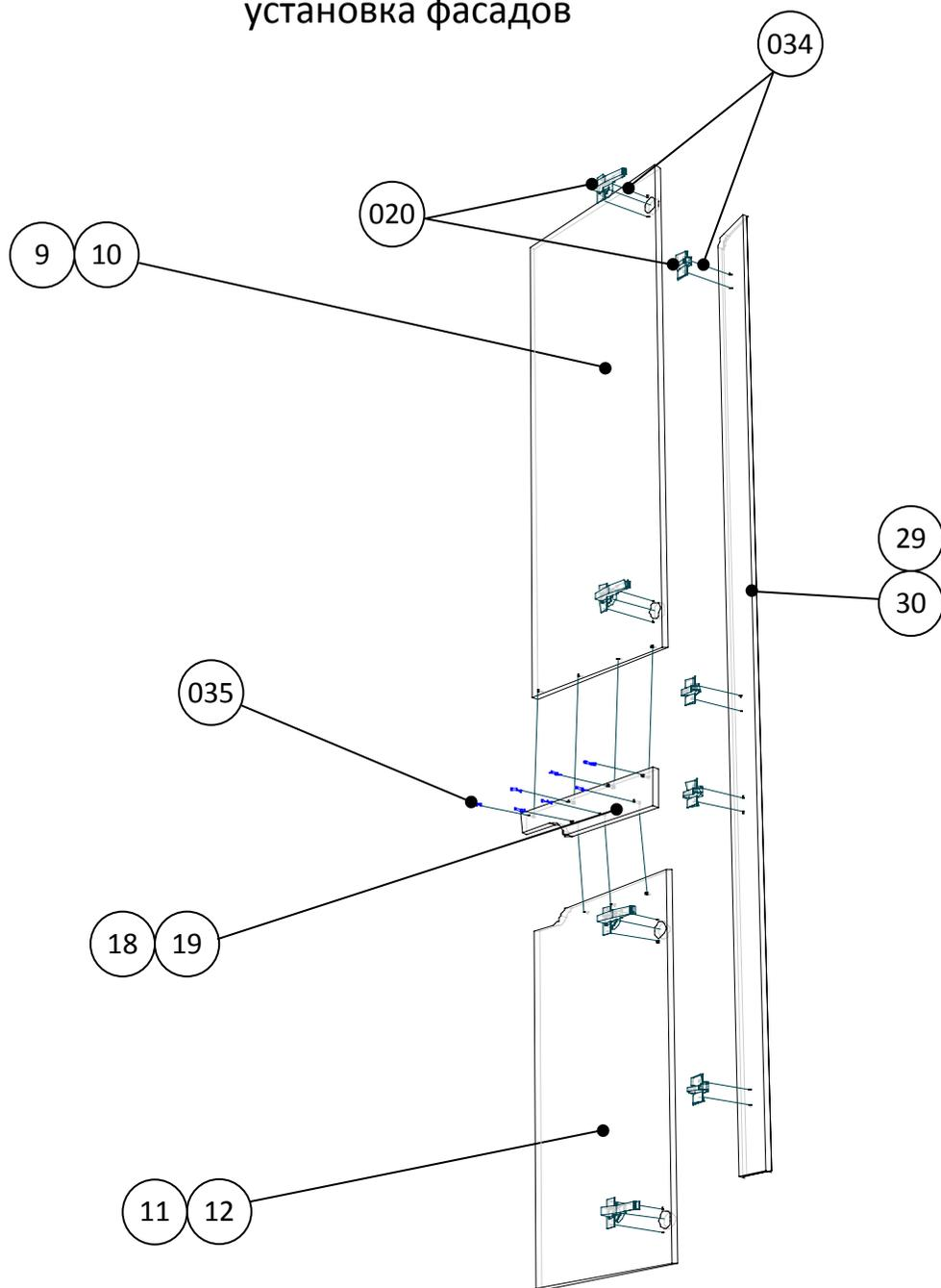
Рисунок 3. Регулировка зазоров между фасадами.
