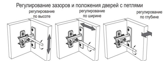
Рисунок 6 - Схема регулировки петель
